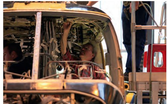
Spantrennung an der Zelle / Frame repair
