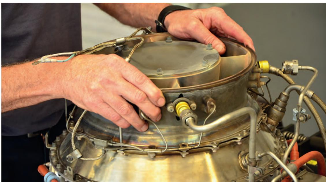
Austausch CT-Disc und PT-Disc / Replacement of CT-Disc and PT-Disc
